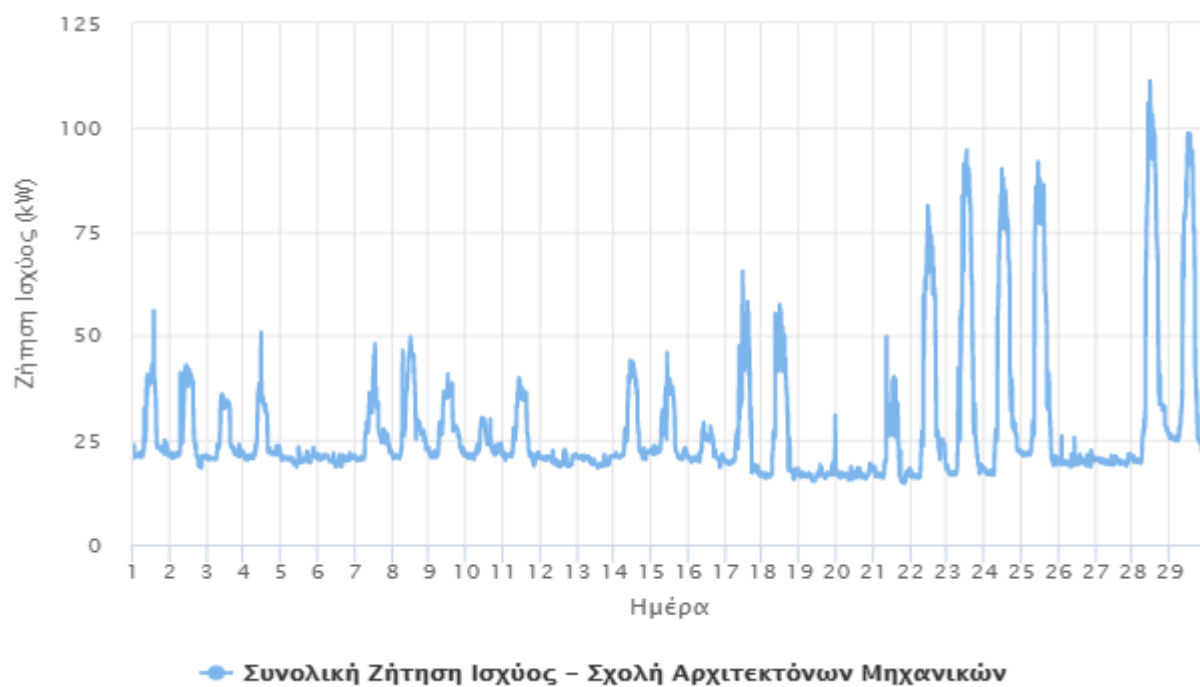
Εικόνα 17: Συνολική ζήτηση ισχύος για το μήνα αναφοράς - Σχολή Αρχιτεκτόνων Μηχανικών
